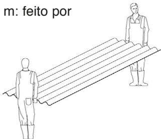
Telhas maiores que 1,53 m: As telhas devem ser manuseadas por duas pessoas segurando na crista da segunda e penúltima onda, nunca pelas bordas laterais, para que não provoquem flexões e trincas longitudinais.
