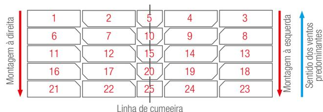
Nos recobrimentos longitudinais, são indispensáveis os cortes de canto nas telhas, distribuídos conforme o desenho abaixo:
