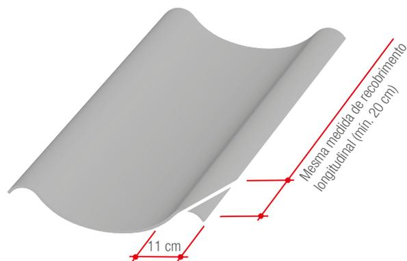
A utilização de um gabarito facilita a marcação dos cortes de canto. Eles devem ser feitos, de preferência, no chão, antes de levar as telhas para o telhado.
