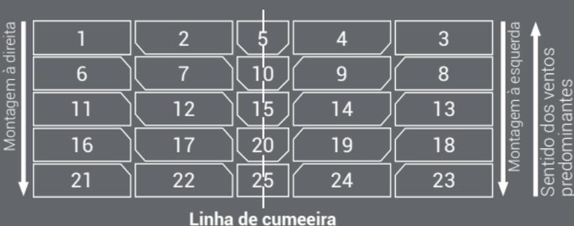
A utilização de um gabarito facilita a marcação dos cortes de canto. Eles devem ser feitos, de preferência, no chão, antes de levar as telhas para o telhado, usando uma serra circular.
